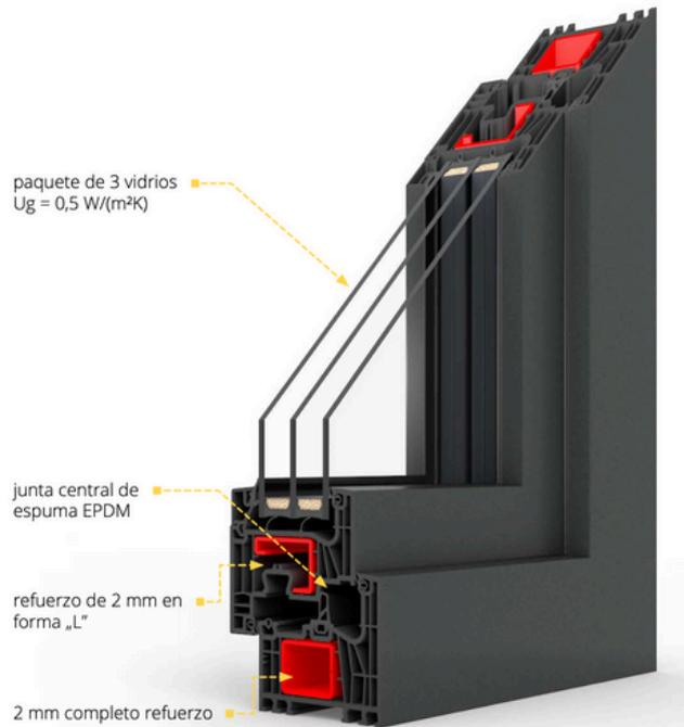
Nuestra nueva ventana tecnológicamente más avanzada se distingue por un excelente parámetro de aislamiento térmico de  $U_w = 0,66 \text{ W/(m}^2\text{K)}$  y una moderna forma de perfil angular. Entre otras cosas, el perfil de 7 cámaras y 3 juntas de EPDM con una junta central, son responsables de los muy buenos parámetros de aislamiento térmico.
